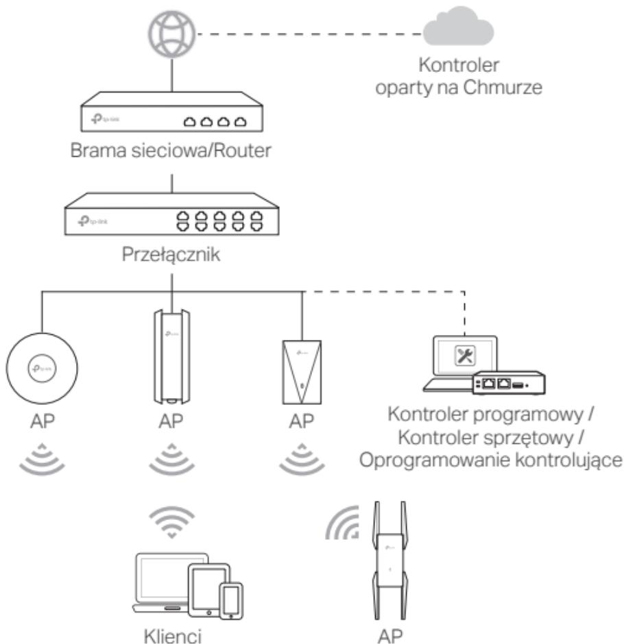
Niektóre AP mogą być konfigurowane i monitorowane centralnie za pomocą kontrolera lub oprogramowania kontrolującego. Aby uzyskać więcej informacji, zapoznaj się ze specyfikacjami i poradnikami produktów, kontrolerów, lub oprogramowania kontrolującego.
