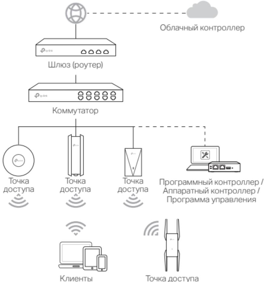
Некоторые точки доступа поддерживают централизованную настройку и мониторинг через контроллер или программу управления. Более подробная информация доступна в характеристиках и в руководстве соответствующего продукта.
